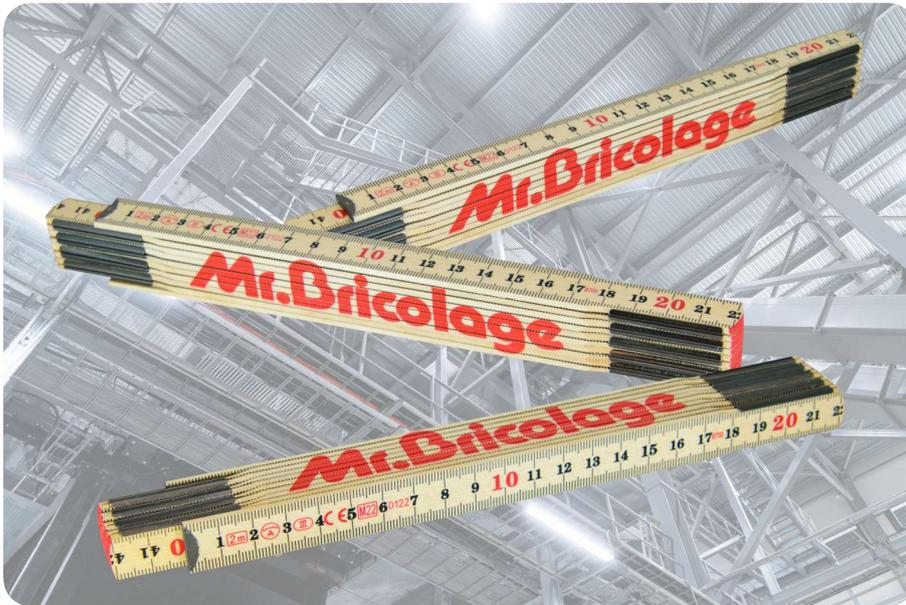
Hochwertiger Glasbirken-Zollstock 2m mit hoher Stabilität und Elastizität z.B. für Schreiner und Tischler. Schlanker Maßstab (Höhe 29mm) durch dünne Glieder mit seitlichen Metallbeschlägen in Anthrazit. Durch geölte Gelenke öffnen und schließen alle Glieder sehr leichtgängig. Verdeckte Vernietung der Anfangs- und Endglieder für optimale Ablesung. Schutzlack für erhöhte Widerstandskraft gegen Schmutz und Feuchtigkeit. Ab 5.000 Stück mit Dezimalzahlen und Enden in Firmenfarben. Made in Germany.
