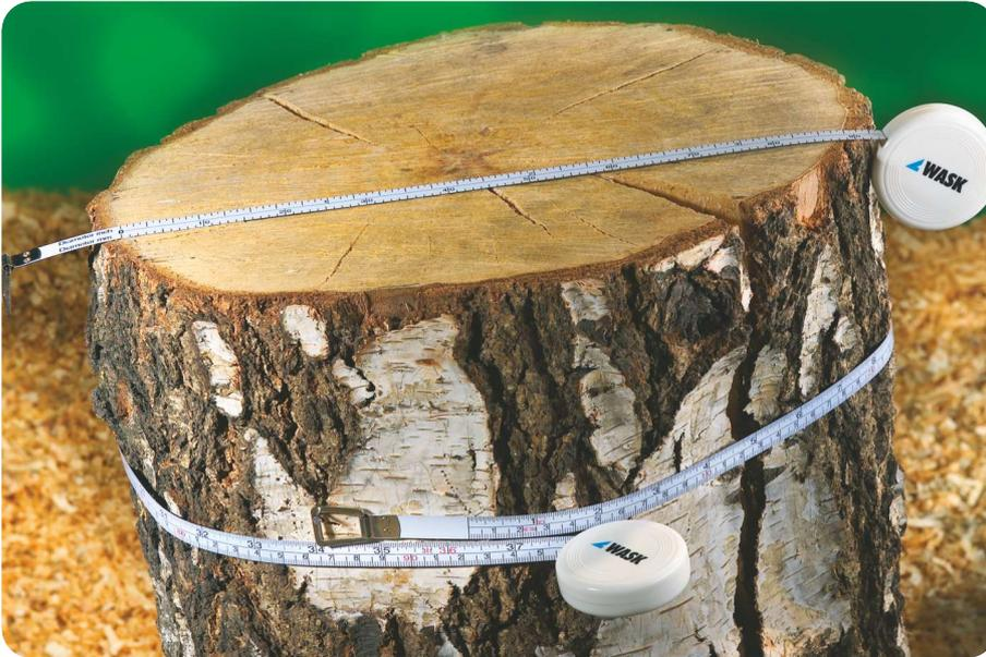
Bestseller-Bandmaß für Umfang- und Durchmesser-Messungen von Rohren, Bäumen, Telegraphenmasten etc. Stahlband mit cm/inch-Skalierung auf Vorderseite. Rückseite mit parallel verlaufender PI-Teilung auf cm- u. inch-Basis. Großer Metallbeschlag am Bandanfang zur Befestigung an Schrauben oder Nägeln. Doming veredelt das Gehäuse sehr.
