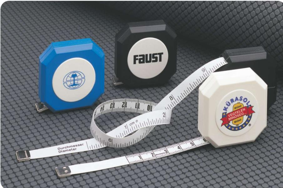
Softbandmaß für Umfang- und Durchmesser-Messungen. Bandvorderseite mit cm-Skala, Rückseite mit parallel verlaufender  $\pi$ -Skalierung. ABS-Gehäuse mit einzigartiger Stopptechnik ohne Stopper. Zum Bändeinzug müssen nur beide Gehäusehälften zusammengedrückt werden. Made in Germany Garantie\* 3 Jahre
